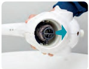
Remova a resistência queimada e substitua a mesma por uma nova. Lembrando que na hora de recolocar a resistência, a mesma deverá entrar através das guias internas da câmara quente.
