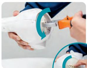
Retire a tampa da câmara quente utilizando um alicate para tirar a pressão de vedação da tampa e após gire com a mão até removê-la por completo.
