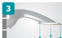
Caso a sua ducha fique com a inclinação que faça com que a água projete mais voltada à parede **2** retire a ducha e na parte traseira gire os parafusos no sentido indicado para ajustar a inclinação da Ducha.
