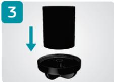
Substitua o filtro por um novo, encaixando na tampa do reservatório.
