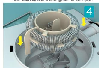
4 Retire a resistência e substitua pela nova.
