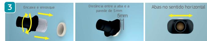
Enrosque o engate fácil na parede, respeitando a distância de 5mm da aba até a parede, e com as abas no sentido horizontal.
