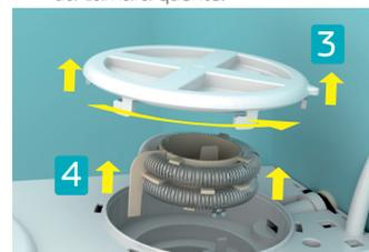
3 Após destravada, retire a tampa da câmara quente.
