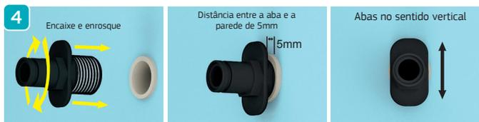
Enrosque o engate fácil na parede, respeitando a distância de 5mm da aba até a parede, e com as abas no sentido vertical.
