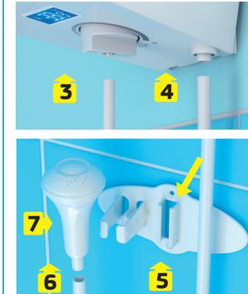
Encaixe a haste de controle a distância no botão de controle na ducha **(3)**. Encaixe a mangueira no engate na ducha **(4)**. Passe a mangueira pelo suporte **(5)** e engate na baby ducha **(6)**. Coloque a baby ducha no suporte **(7)**. Após concluir todos os passos de instalação, abra o registro e verifique a vedação da ducha.
