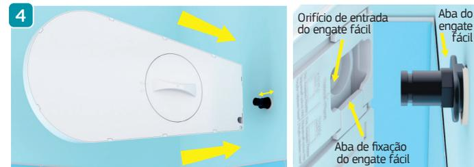
Gire a ducha a 90° (posição vertical) e encaixe a ducha no engate fácil, empurrando até encostar na parede.
