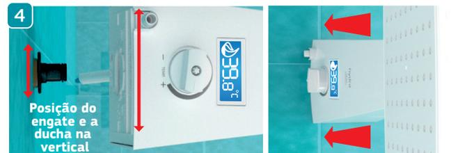
Gire a ducha a 90° (posição vertical) e encaixe a ducha no engate fácil, empurrando até encostar na parede.
