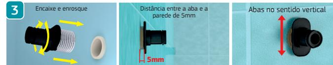
Enrosque o engate fácil na parede, respeitando a distância de 5mm da aba até a parede, e com as abas no sentido vertical.
