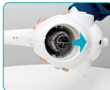
Remova a resistência queimada e substitua a mesma por uma nova. Lembrando que na hora de recolocar a resistência, a mesma deverá entrar através das guias internas da câmara quente.
