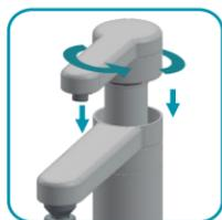
Desrosqueie a bica purificador do corpo superior e desencaixe o elemento filtrante antigo. Encaixe o novo elemento filtrante na bica purificador, em seguida encaixe e rosqueie a bica purificador no corpo superior (câmara quente).
