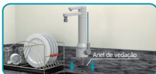
Insira o anel de vedação na rosca, conforme ilustração, em seguida, posicione o produto no orifício da bancada.
