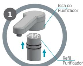
Pressione e encaixe o refil purificador na bica.
